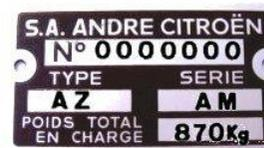
Plaque du constructeur portant le type et le n° de série, rivée sur la traverse de plate-forme AV à D.
