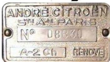
Plaque du n° moteur, rivée sur le bloc moteur à proximité du démarreur.
